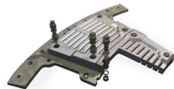
Fijación de placas de tabique doble rotator
