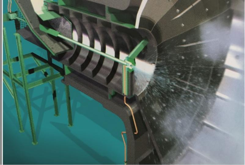
El sistema automatizado de Inyección de Agua Estanda asegura el mantenimiento de las temperaturas óptimas de trabajo. Para establecer el equipo idóneo, primero es necesario un estudio de la situación térmica del molino.
